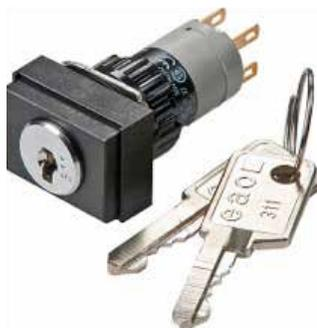
**1- ON-OFF**, interruptor o automático activado por un sistema de cerradura, que permite la activación y desactivación total del Pupitre de control a través de una llave. La llave no deberá quedar puesta al terminar los trabajos, el Pupitre de Control debe quedar desconectado y las llaves deben quedar a cargo de una persona designada u/o supervisor, así evitar que personal ajenos al uso del equipo pueda activarlo.
