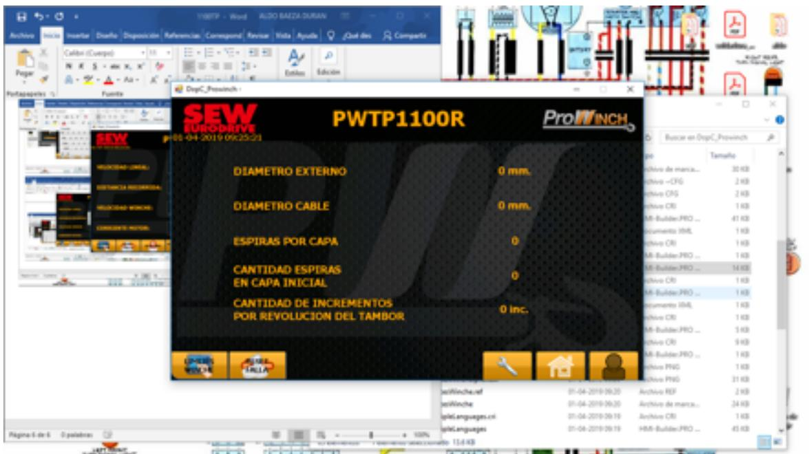
En la pantalla principal aparece abajo un botón con una llave, al digitar ingresan a la pantalla en que se ingresan los parámetros para que el programa calcule las variables que se muestran en las pantallas de operación.
